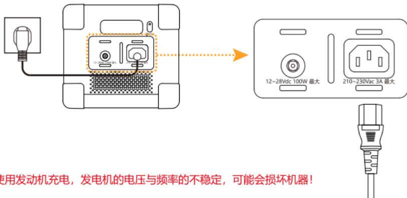
⚠ 使用发动机充电，发电机的电压与频率的不稳定，可能会损坏机器！
